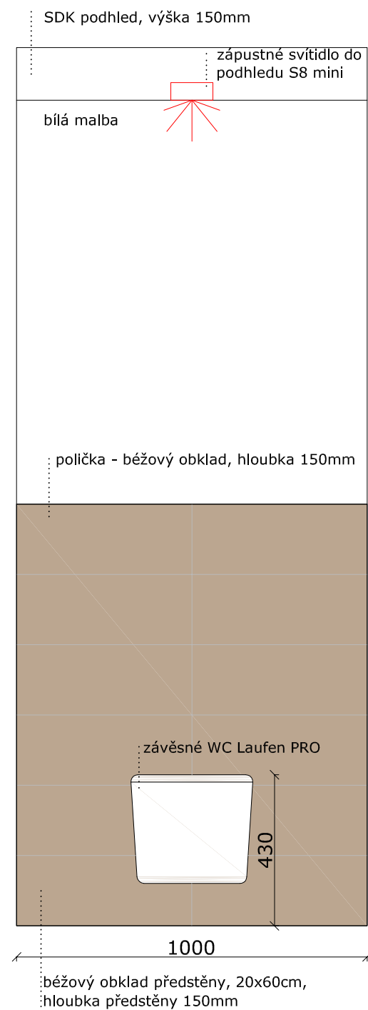
POHLED NA PŘEDSTĚNU
